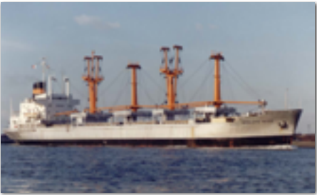
Neddloyd Niger, algemeen vrachtschip, in 1971-gebouwd 12,205-dwt, 6 cilinder MAN K70, gebouwd bij Howaldswerke in Hamburg. Gesloopt in India 20 November 1999 waar ze op het strand van Alang is gesloopt.
