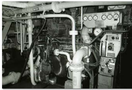
Koppenbordes, manoeuvreerstand en schroefastunel. Aan beide kanten van de motor zit een turbo blower. Op een niet echt makkelijke plek!
